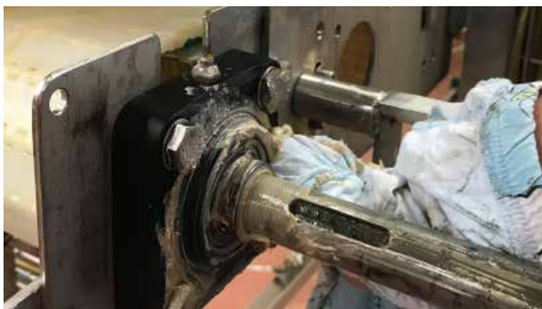
Die Lappen für die manuelle Trockenreinigung sind nicht wiederverwendbar und müssen verbrannt werden.
