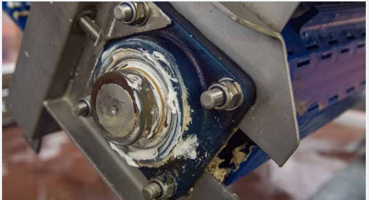
Überschüssiges Lagerfett, das auf das Förderband gelangt, kann Bakterien oder Allergene in die Lebensmittelzone eintragen und die Lebensmittelsicherheit gefährden.
